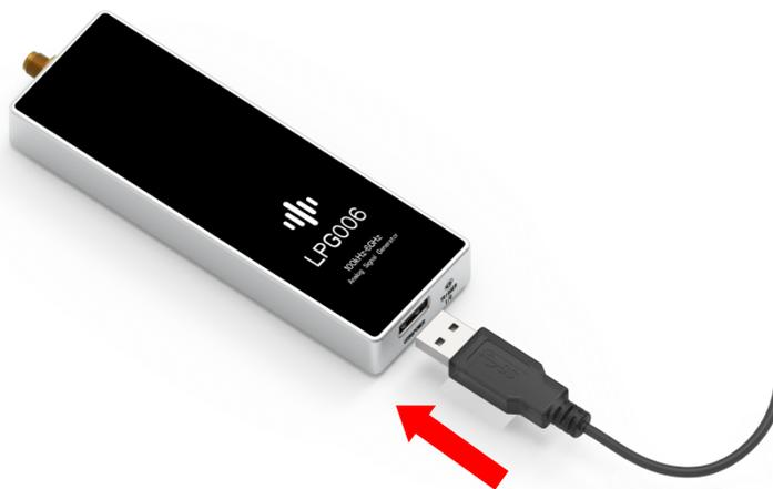
图 7. 连接电源与控制
